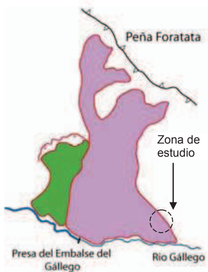
Esquema geomorfológico del paleodeslizamiento de flujo desarrollado bajo la Peña Foratata
